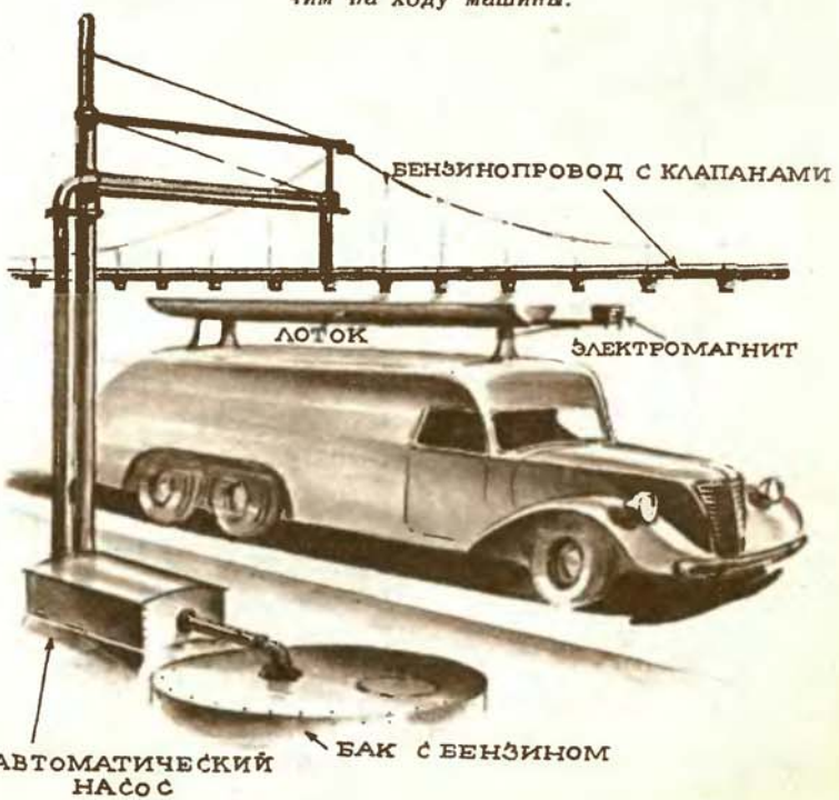
Приспособление для автоматической заправки моторов горючим на ходу машины.
