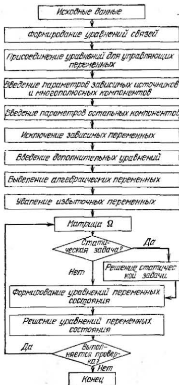
Рис 2.10. Структурная схема общей процедуры моделирования электрических схем в пространстве переменных состояния.
