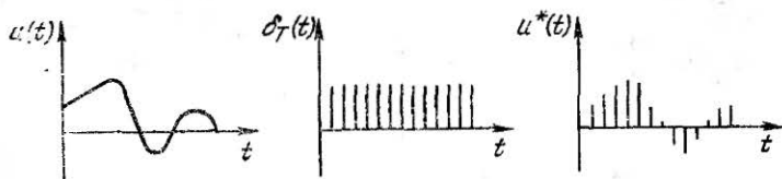
Рис. 4.4. Представление процесса квантования как модуляции последовательности импульсов.
