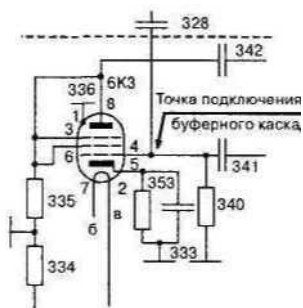
Рис. 2.32. Схема расположения элементов буферного усилителя (М1:1)
