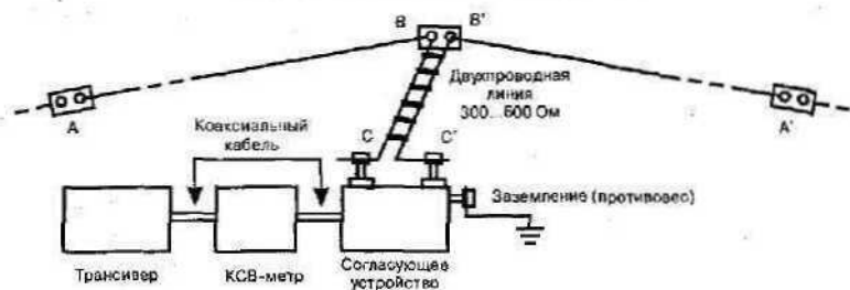
Рис. 4.В. Конструкция антенны «Levy»
