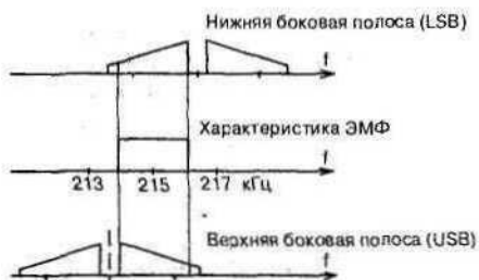
Рис. 1.10. Формирование SSB сигнала фильтровым методом
