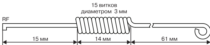
Рис. 6.20. Антенна. Внешний вид и габаритные размеры
