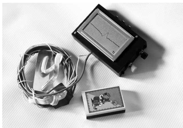
рис.2. Особенностью кардиографа накладного типа является то, что один из электродов непосредственно закреплен на задней стенке корпуса прибора, за счет чего уменьшается число соединительных проводов.
