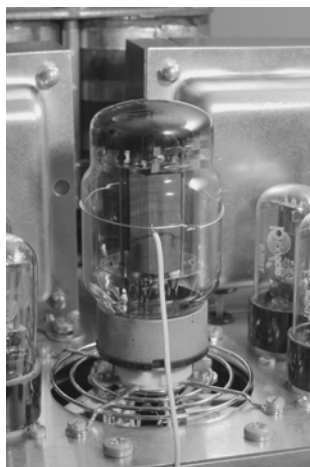
Рис. 2.52. Шарик термопары, закрепленный на колбе лампы с использованием тонкого медного провода
