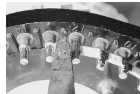
Рис. 8.9 Пайка резисторов для поверхностного монтажа с применением кондуктора. Пайка очередного резистора начинается с того штыря переключателя, к которому подходит еще не припаянный конец предыдущего резистора
