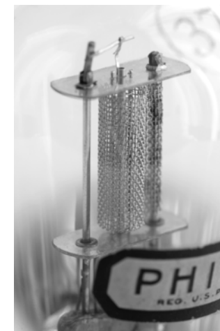
Рис. 2.48 Внешний вид «плетеного анода» лампы Philco 37
