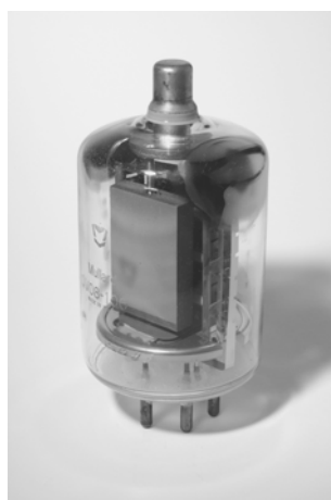
Рис. 2.50 Графитовые анодные пластины тетрода QV08-100
