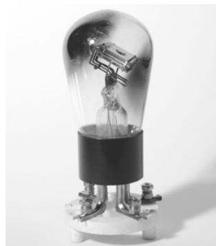
Рис. 2.40 Лампа P215 с катодом прямого накала, имеющего оксидное покрытие
