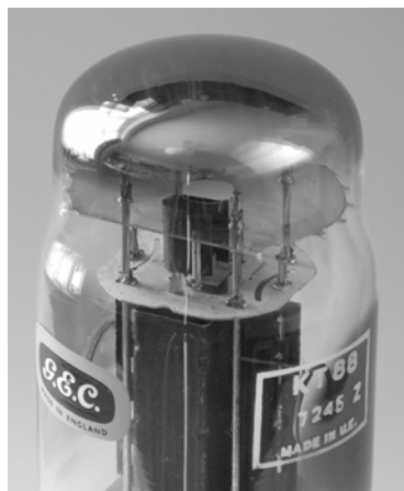
Рис. 2.51 Внешний вид лампы типа KT88 компании GEK, следует обратить внимание, что размеры выбраны из соображений снижения токов утечки
