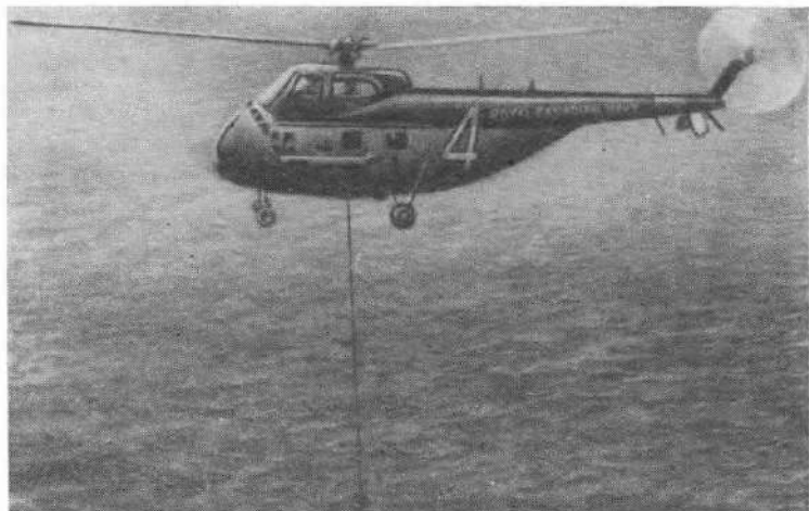
Вертолет Канадского военно-морского флота с опускающей гидроакустической станцией во время учения по обнаружению и уничтожению подводных лодок.
