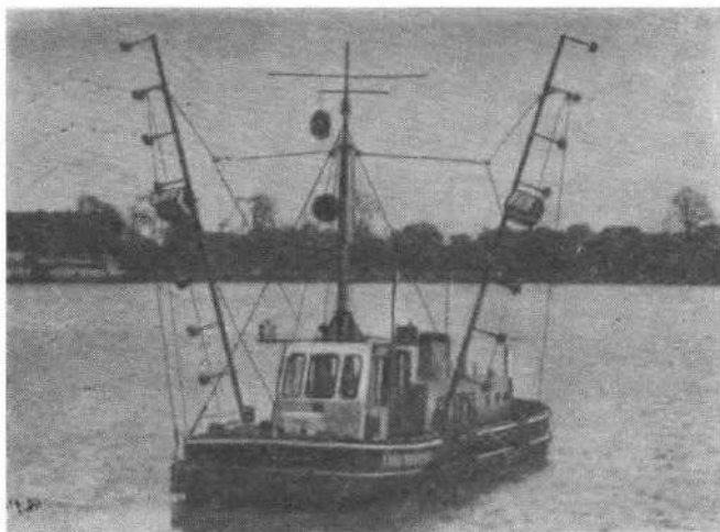
По бортам судна — не грузовые стрелы, а штанги с вибраторами эхолота. Они опускаются на воду, как только судно начинает эхолотирование.
