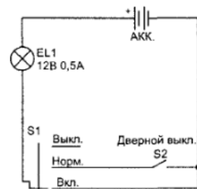
Рис. 1.3. Типичная схема освещения салона
