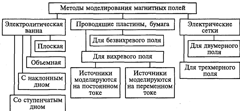
Рис. 4.4. Методы моделирования магнитных полей с помощью электрических моделей-аналогов
