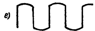
Рис. 186. Формы импульсов, наблюдаемых на экране осциллографа при исследовании искажений в низкочастотной части спектра.
