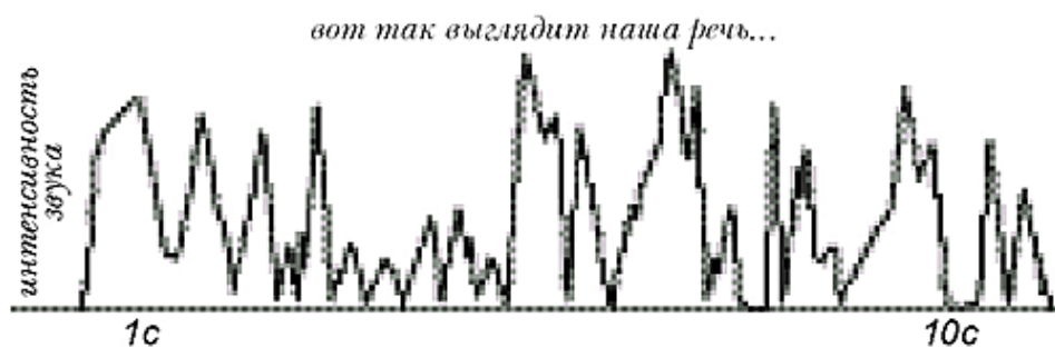
Рис. 8 Осциллограмма речевого сигнала
