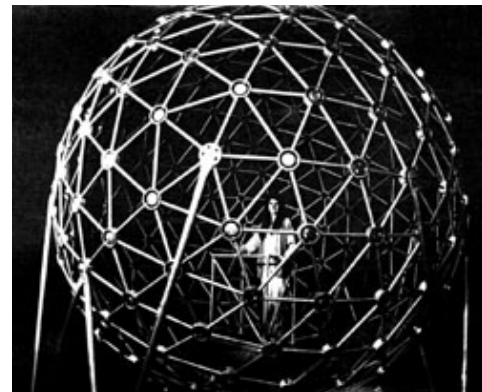
Рис.4 Размещение громкоговорителей на сфере в заглушенной камере
