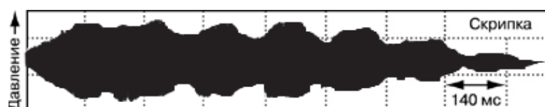
Рис.1 Временная структура и спектральный состав ноты С4 (до первой октавы), сыгранной на скрипке
