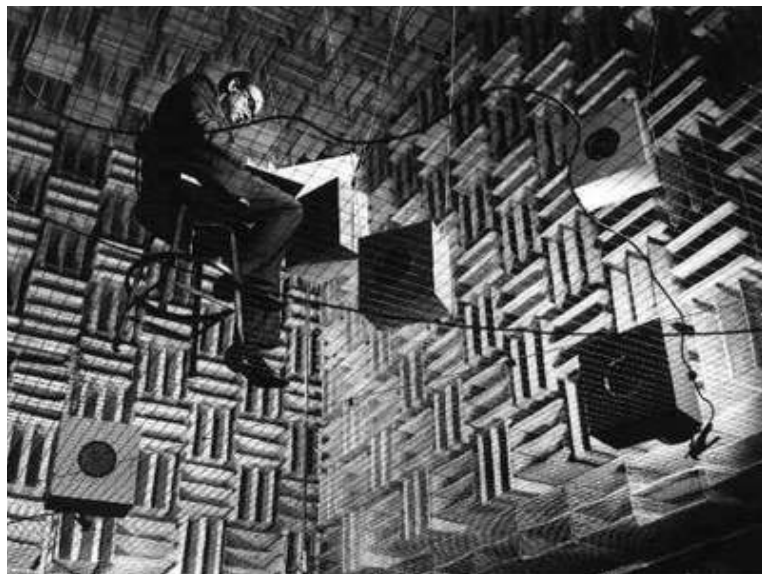
Рис 1 Моделирование параметров помещения в заглушенной камере
