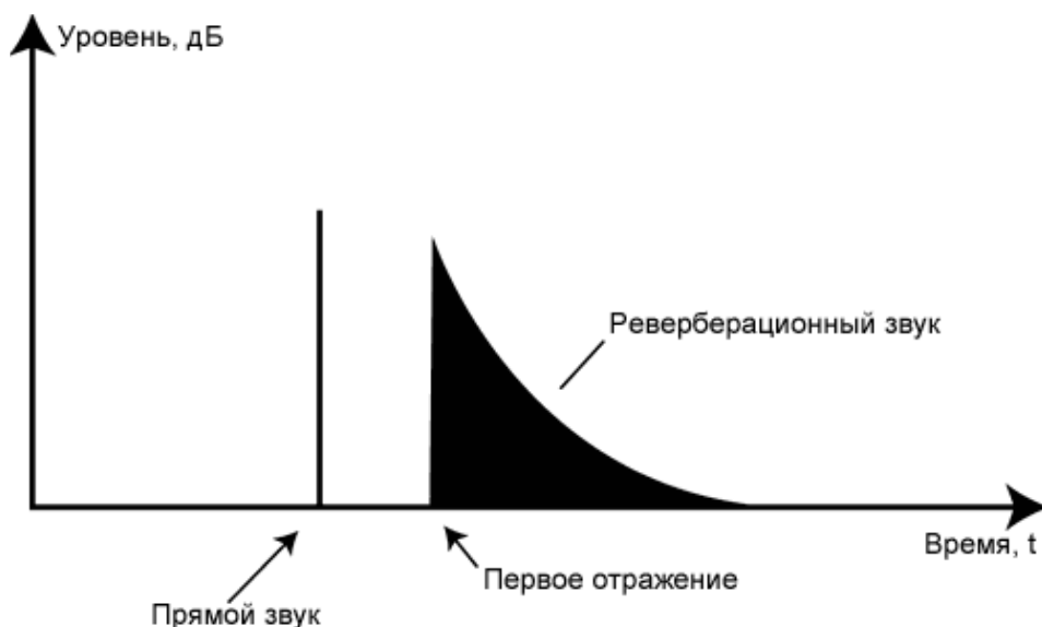
Рис. 2. Интервал времени между прямым звуком и первым отражением
