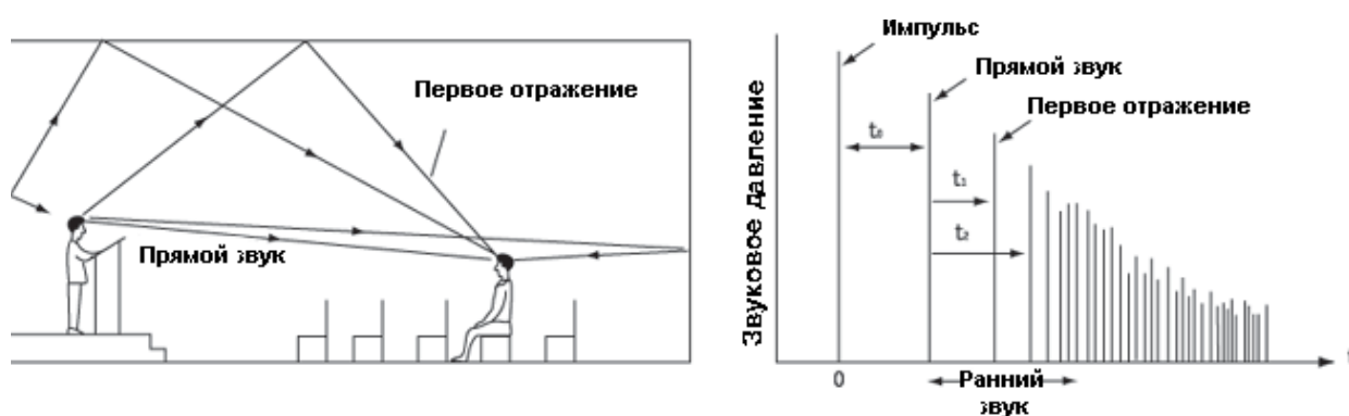
Рис.6 Структура отраженных сигналов в помещении
