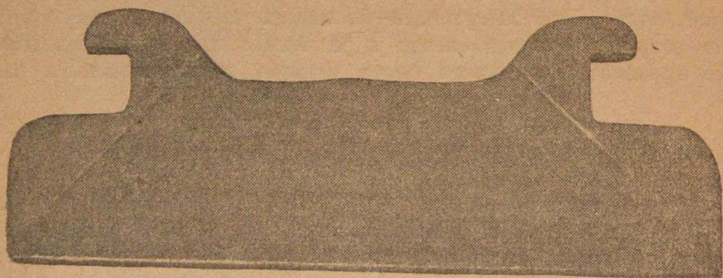
Фиг. 8. Колосники чугунные, алитированные 6 час. при 980—1000° в порошке сплава Fe-Al-Cu (с содержанием 42,2% Fe, 2,2% Cu) + 2% NH 4 Cl; слой алитирования — около 0,2 мм; диффузионный отжиг 3 часа при 900°.
