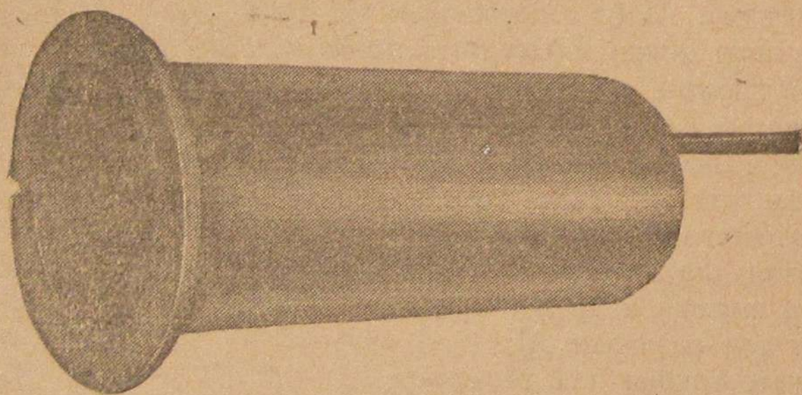
Фиг. 9. Муфель для нитроцементации, алитированный 6 час. при 980° в порошке сплава Fe-Al-Cu (с содержанием 55% Al, 3,4% Cu) + 0,25% NH 4 Cl; расход старого сплава 75% + 25% свежего сплава.
