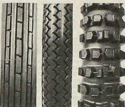
Рис. 1. Протектор шин для переднего колеса гоночных мотоциклов имеет не только продольные, но и поперечные канавки.
