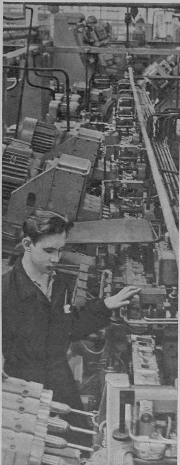
На автомобильном заводе имени Лихачева начал выпуск автомобилей ЗИЛ-130. На снимке: автоматическая линия по обработке блока цилиндров автомобиля ЗИЛ-130. На первом плане — наладчик автоматической линии Юрий Мазанин. Фото В. Бровка.
