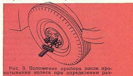
Рис. 3. Положение прибора после поворота колеса при определении развала.
