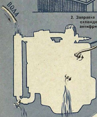
1. Промывка системы охлаждения.
