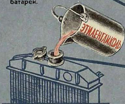
2. Заправка системы охлаждения антифризом.
