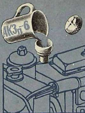
5. Замена смазки в картине двигателя.
