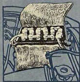
3. Утепление аккумуляторной батареи.
