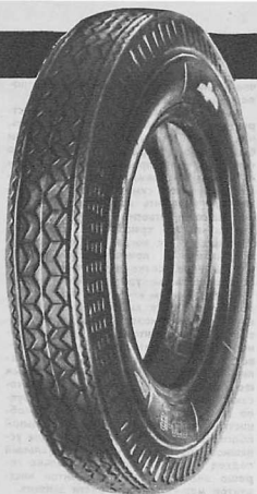
Шина (для легкового автомобиля) с рисунком протектора повышенной износостойкости.
