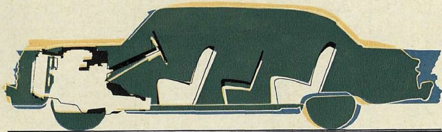
Сравнение компоновки автомобилей «Чайка» (голубой) и ГАЗ-12 (желтый)
