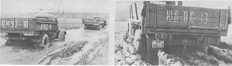
Рис. 2. Преодоление труднопроходимого участка местности помощью цепей противоскольжения.
