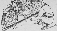
Рис. 2. Проверка положения колес мотоцикла в горизонтальной плоскости.
