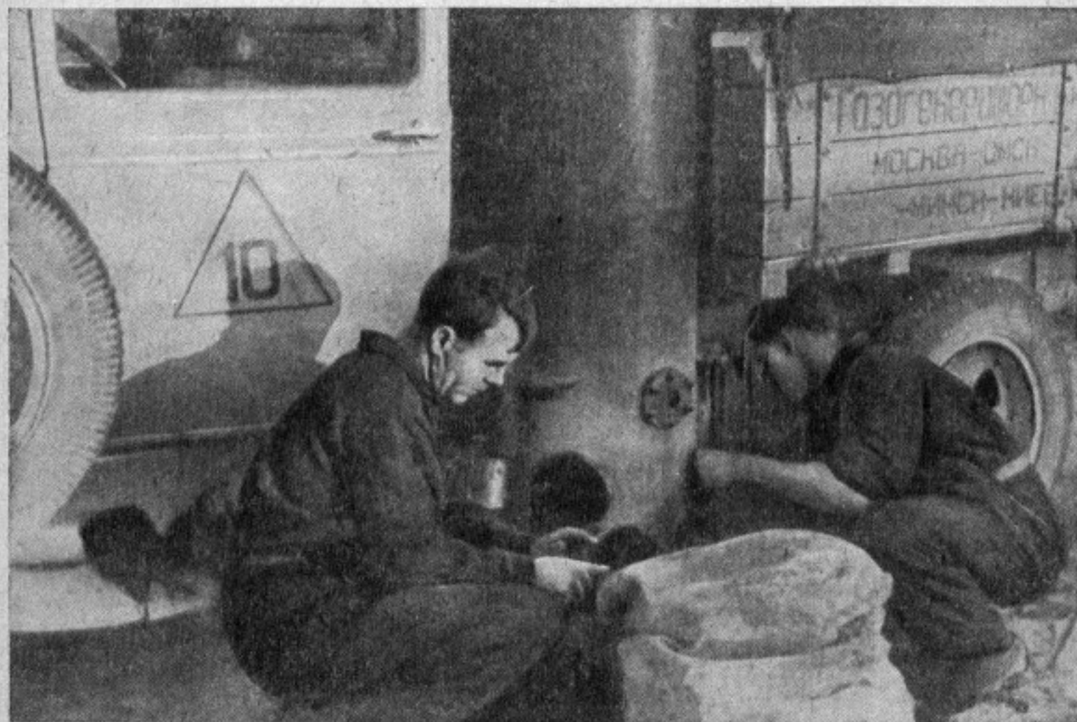
На профилактическом осмотре. Водители машины № 10 тт. Быстров и Елизаров чистят газогенераторную установку
