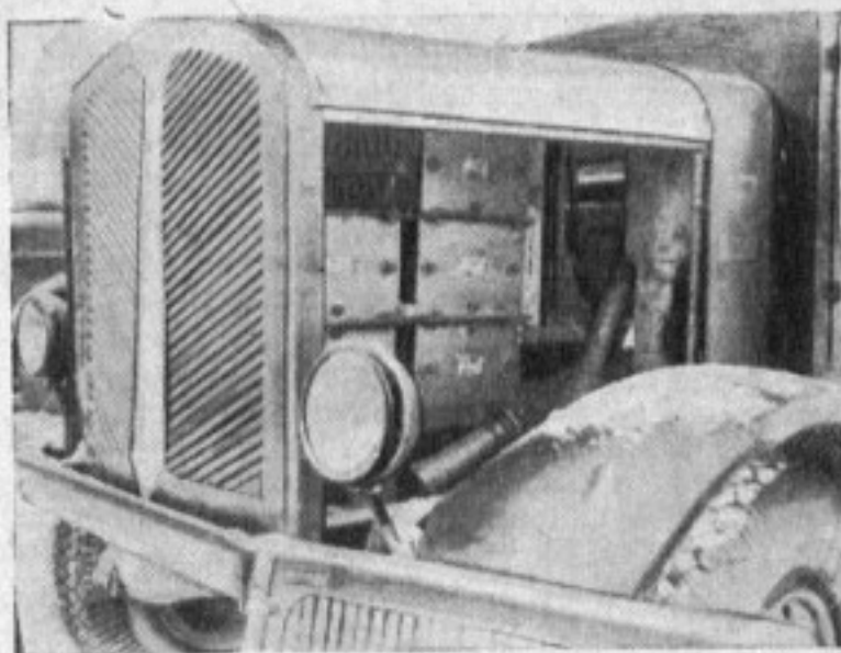
Рис. 2. Расположение силового реостата грузового троллейбуса
