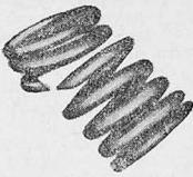
Рис. 1. Лопнувшая клапанная пружина
