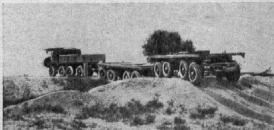
Рис. 6. Четырехосные грузовики с прицепами предназначены для транспортировки грузов в условиях почти полного бездорожья
