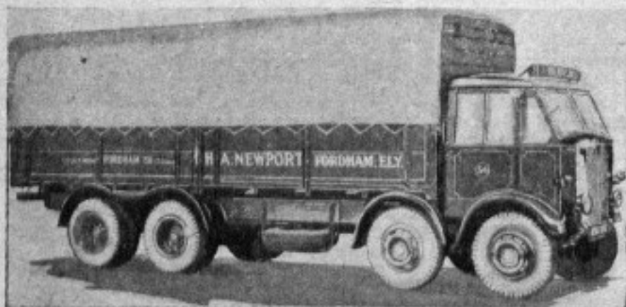
6 Рис. 1. Четырехосный грузовик повышенной грузоподъемности фирмы АЕС. Полезная нагрузка 14,5 тонн
