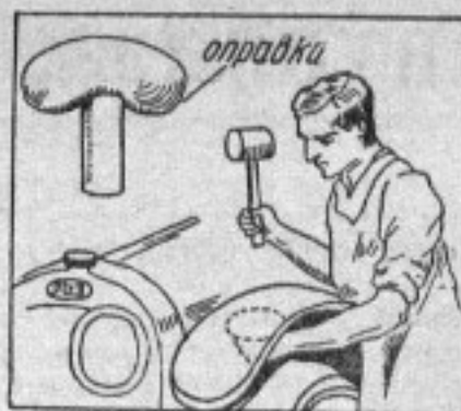
Рис. 2. Слева — приспособление для правки крыла, справа — момент правки крыла с помощью оправки и молотка
