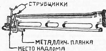
Рис. 1. Приварка отломившегося куска от головки мотора
