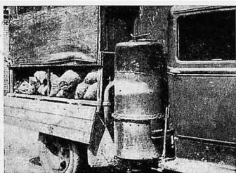
Цилиндрическая печь газогенераторной установки проф. Наумова. У нижней части кузова — запасы древесного угля, применяемого в качестве топлива
