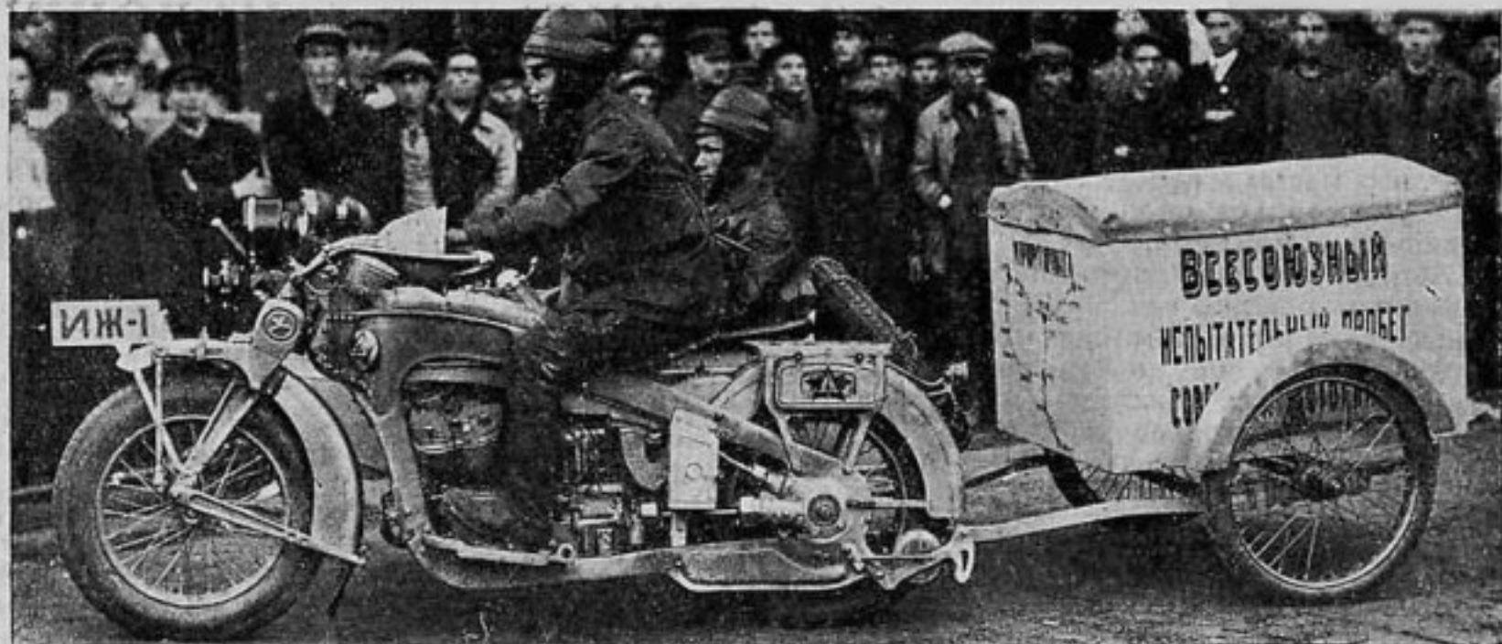
Первая опытная модель мотоцикла Ижевских заводов
