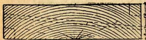
Диагональная распиловка досок
