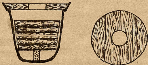
Рис. 2. Слева в разрезе котел, загруженный материалом и покрытый деревянной крышкой. Справа крышка.
