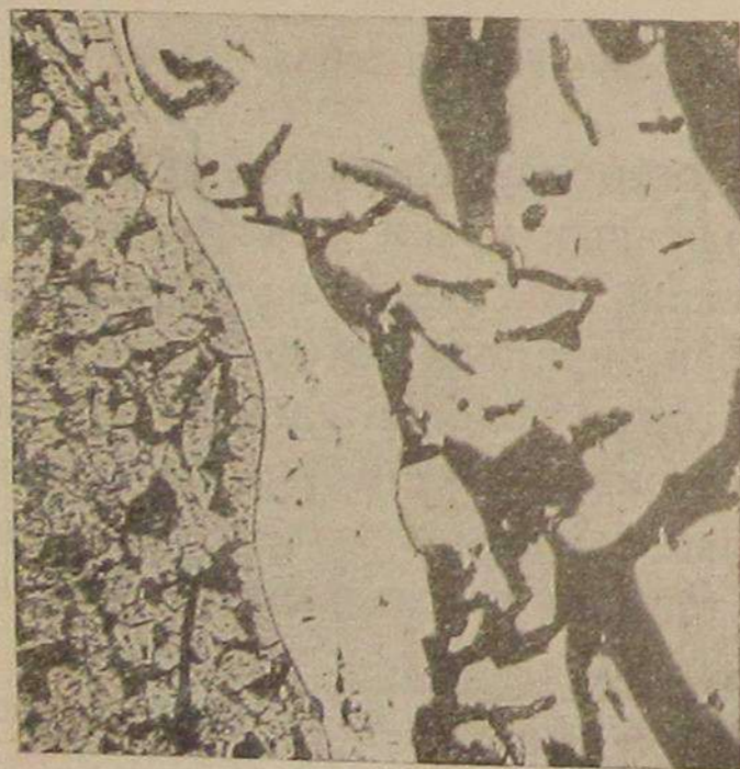
Фиг. 12. Травлено \text{HNO}_3 . Начало диффузии Al в Fe. \times 95 .
