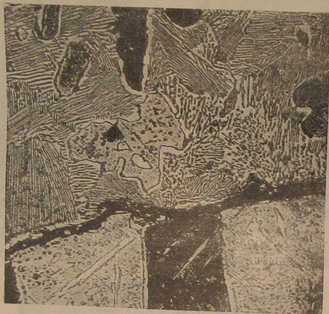
Фиг. 51. Травление \text{HNO}_3 + \text{HFe} . Выдержка 2 часа 1100 \times 250 .
