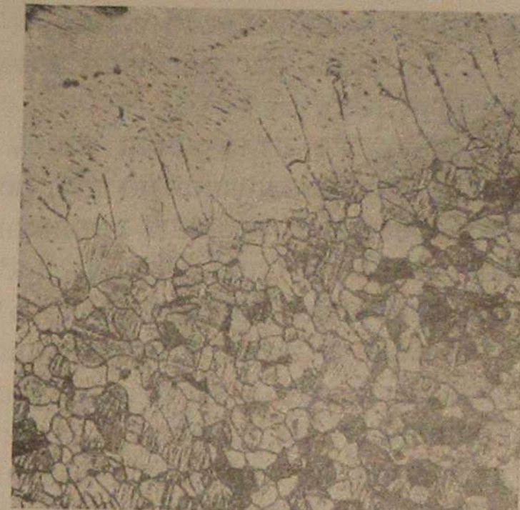
Фиг. 33. Травление \text{HNO}_3 . То же, что фиг. 32. \times 70 .
