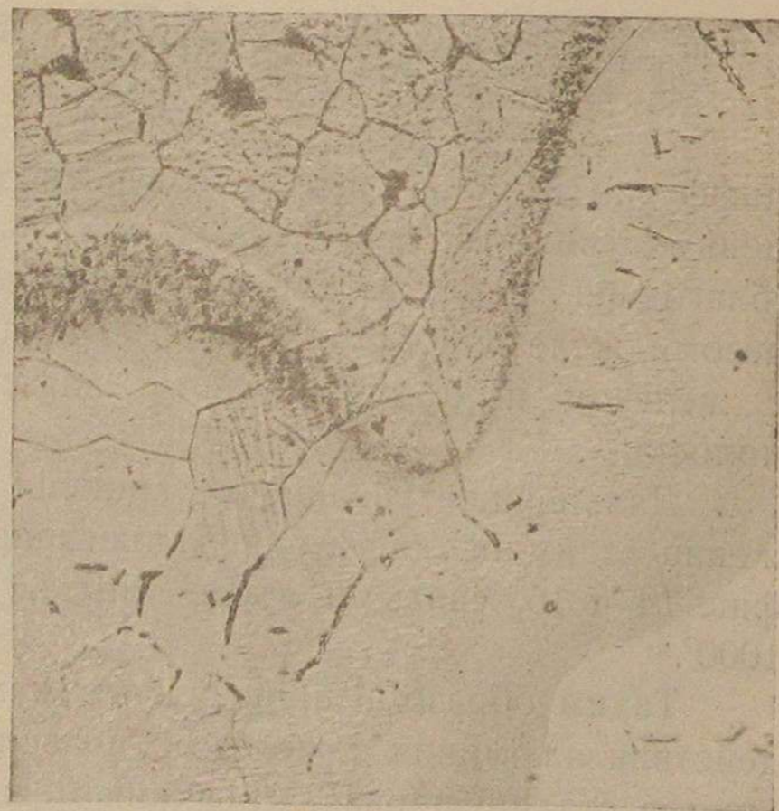
Фиг. 17. Травлено HNO 3 . То же, что фиг. 16. × 230.
