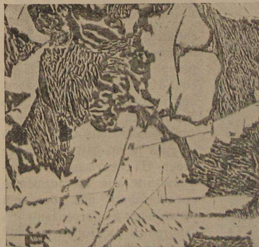
Фиг. 22. Травление NaOH. Сплав Fe Al, содержащий 38,69% Al. \times 270 .
