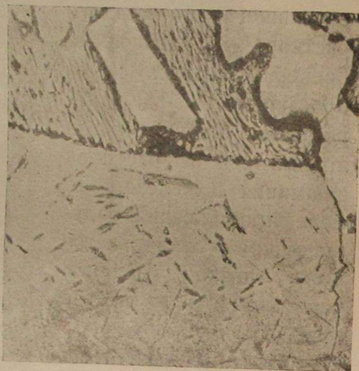
Фиг. 29. Травление \text{NaOH} . То же, что фиг. 23. \times 278 .
