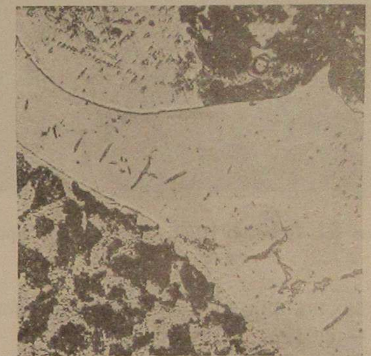
Фиг. 15. Травление \text{HNO}_3 . Диффузия Al в Fe. \times 230 .
