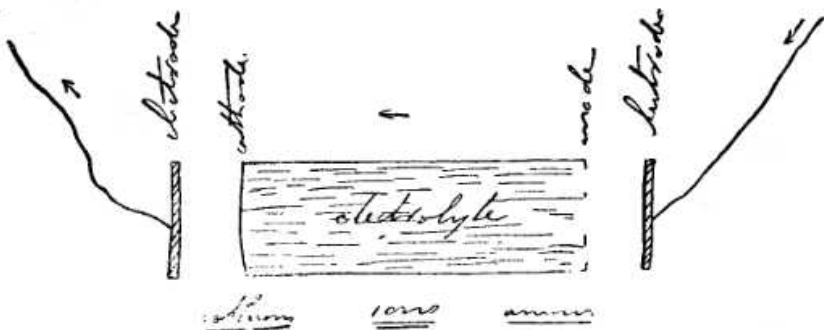
Чертеж Фарадея, где впервые приведены новые электролитические наименования: катион, анион, электролит, катод, анод.
