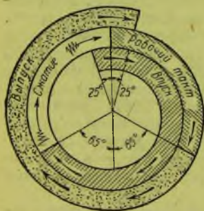
Рис. 18. Диаграмма газораспределения двигателя TI3-AM-600
