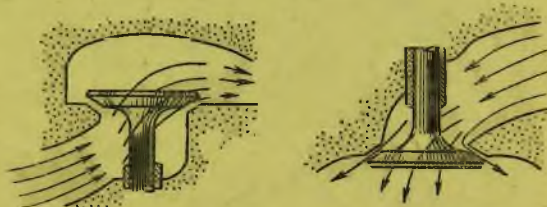
Потоки газов при верхних и нижних клапанах
