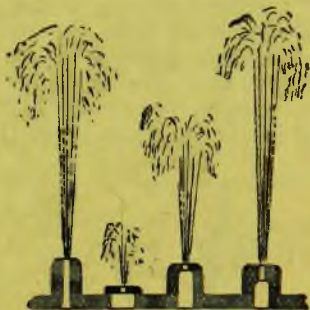
Рис. 102. Жиклеры одинаковых диаметров могут иметь разную производительность
