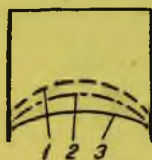
Рис. 95. Регулирование качества смеси при помощи изменения выреза дроссельной заслонки
