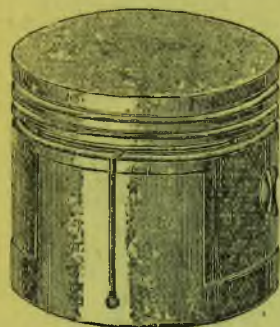
Рис. 29. Поршень мотоцикла ПМЗ-А-750.
