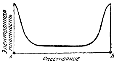
Рис. 54. Распределение электронной плотности в металлическом магнии в зависимости от расстояния между двумя соседними атомами A и B (по данным Фурье-анализа).
