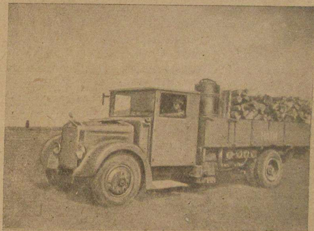
Рис. 3. Автомобиль Грэф-Штифт с газогенераторной установкой Кромаг.
