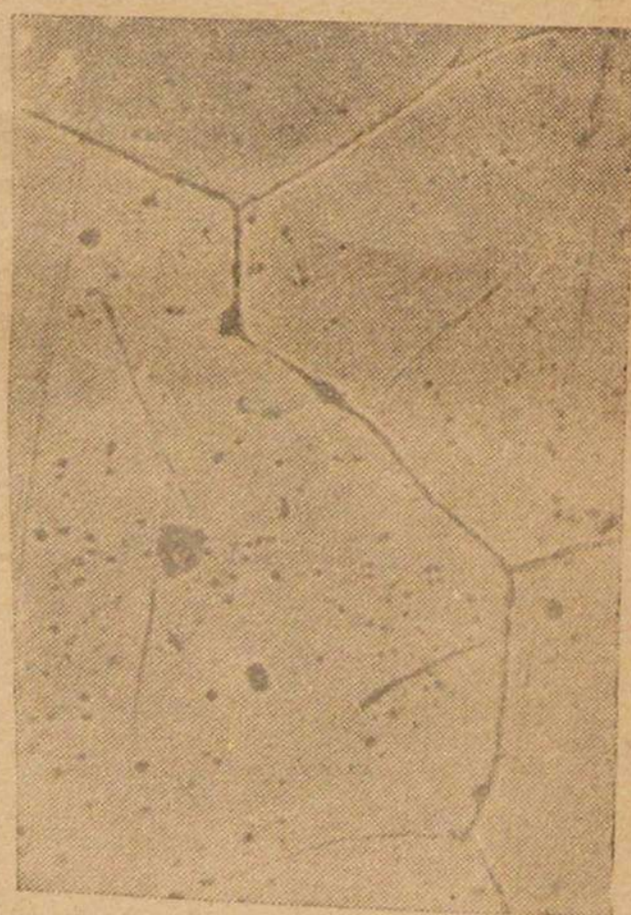
Фиг. 16. Сплав Fe—Al (76,94% Fe) \times 100 . Травление NaOH
