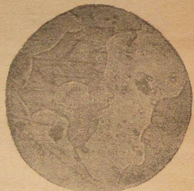
Фиг. 7. Литой сплав Fe—Al (42,2% Fe) \times 250 . Электролитическое травление
