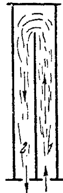
Рис. 142. Схема огневой модели пары вертикалов без рециркуляционного окна внизу разделительной стенки.
