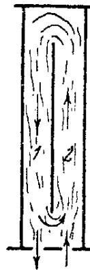
Рис. 143. Схема огневой модели пары вертикалов с окнами вверху и внизу в разделительной стенке.
