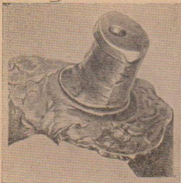
Фиг. 74. Износ шипа крестовины кардана.
