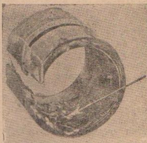
Фиг. 73. Втулка кардана "Спейсер" после заедания шипа.
