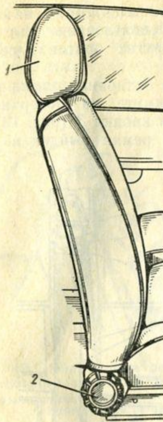
Рис. 11. Переднее сиденье: 1 — подголовник; 2 — рукоятка фиксации наклона спинки
