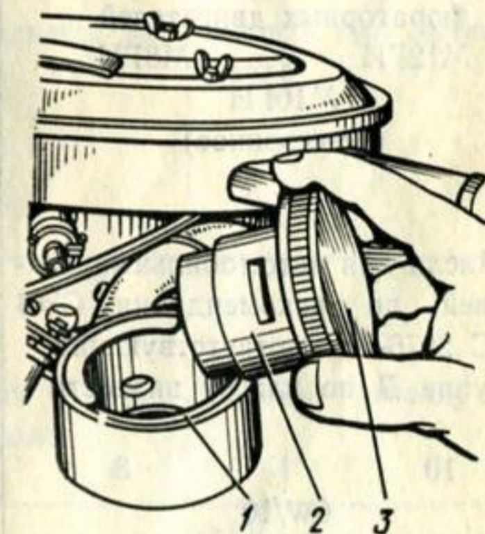
Рис. 36. Маслонаполнительная горловина картера двигателя:
