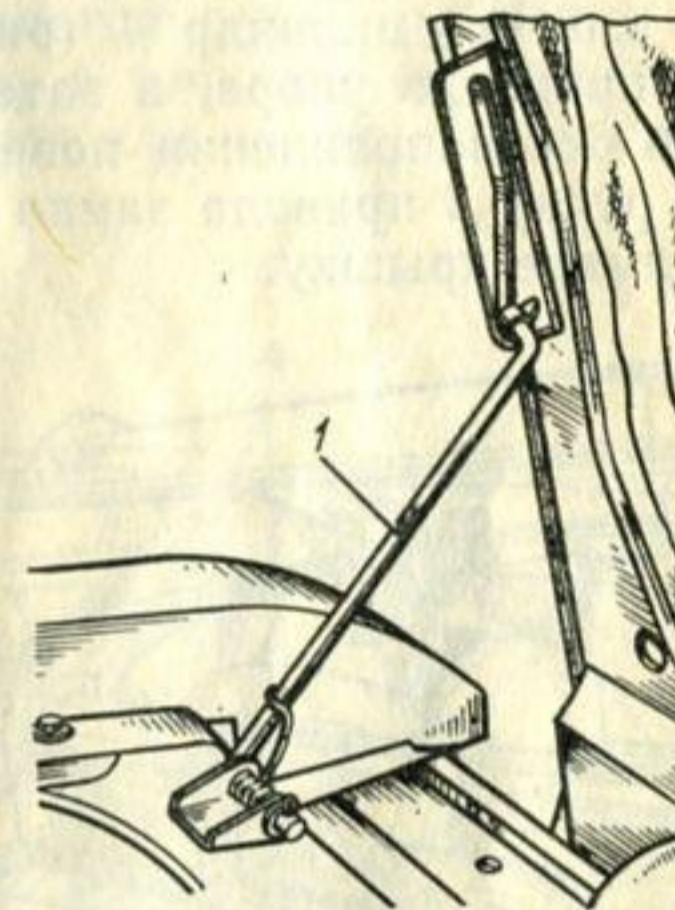
Рис. 8. Упор капота: 1 — стойка упора
