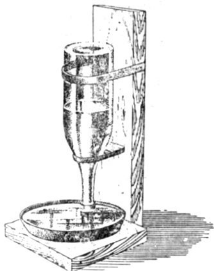
Рис. 120. Автоматическая поилка для птиц, регулируемая давлением воздуха.
