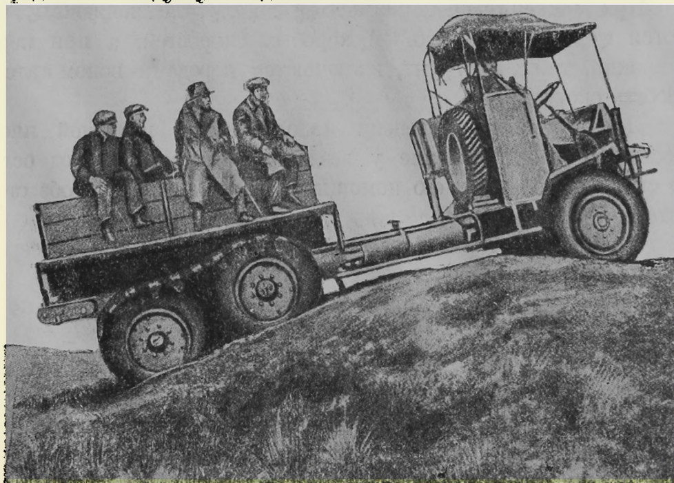
Фиг. 40. Боковой вид дизельного вездехода Кросслей при испытании на под'еме.
