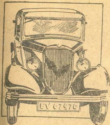
Фиг. 48. Форд, модель «Генри-8», вид спереди. Радиатор предохранен решеткой. Подфаркам придана обтекаемая форма, и они вделаны в крылья. Переднее стекло поднимается вверх
