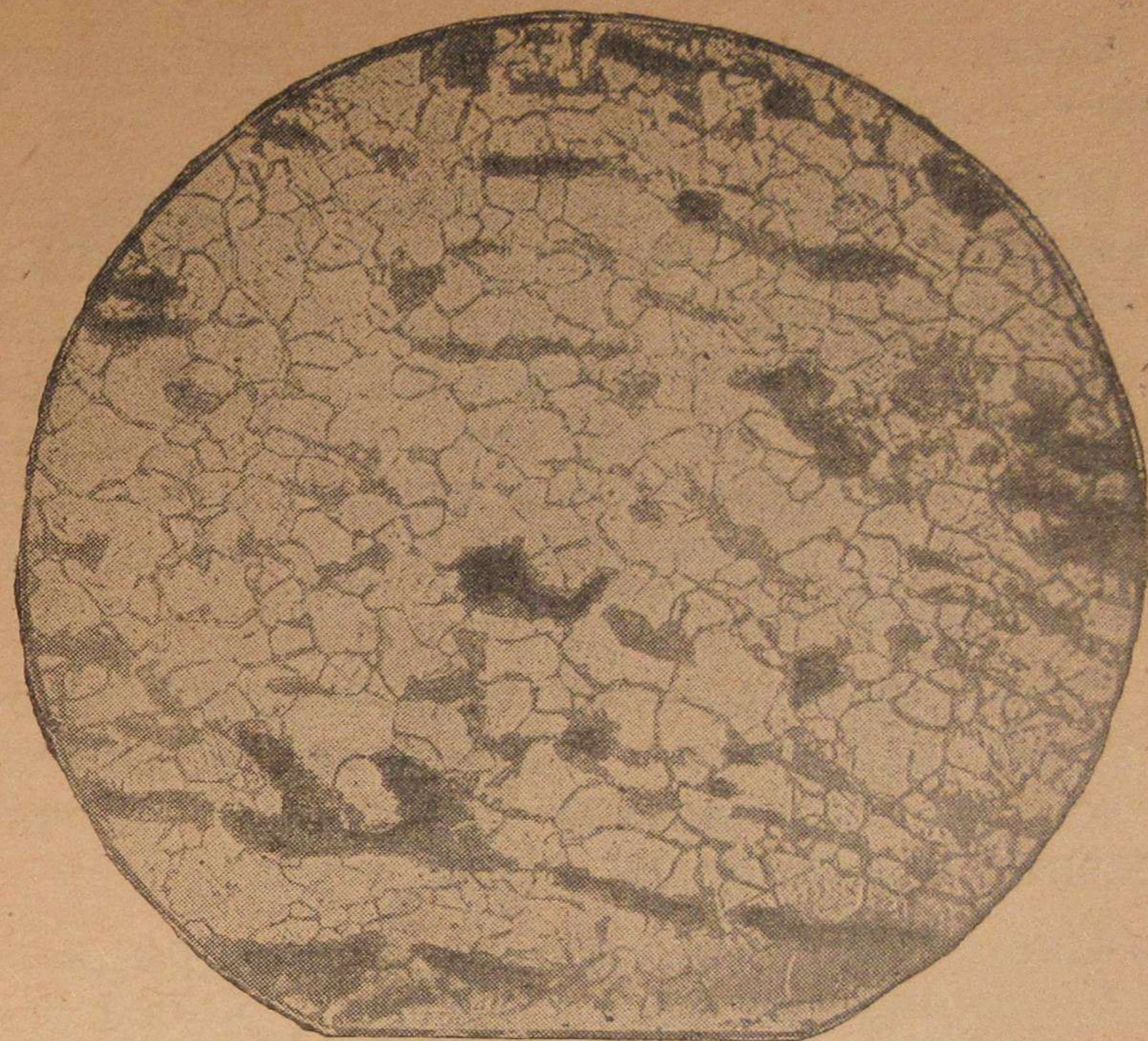
Фиг. 1. Исходная микроструктура литейного инструмента.
