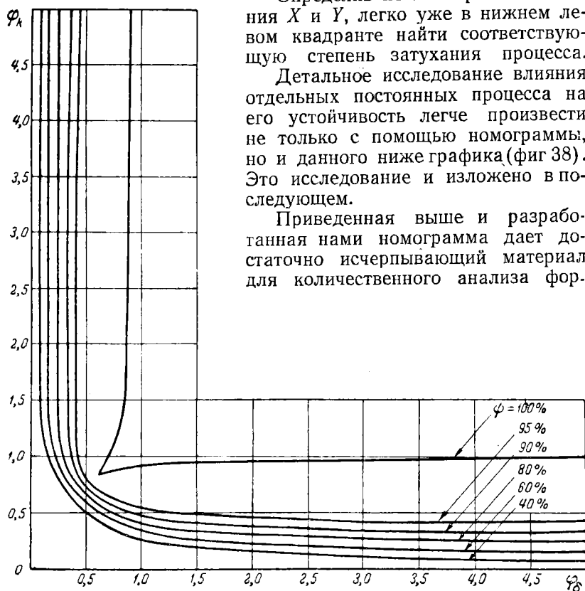
Фиг. 38. График кривых равного затухания в коэффициентах \varphi_{\delta}(i) и \varphi_R(i) .
