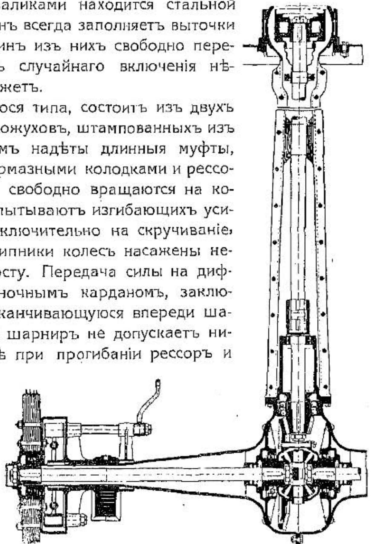
Рис. 232. Задній мостъ шасси Дессау.
