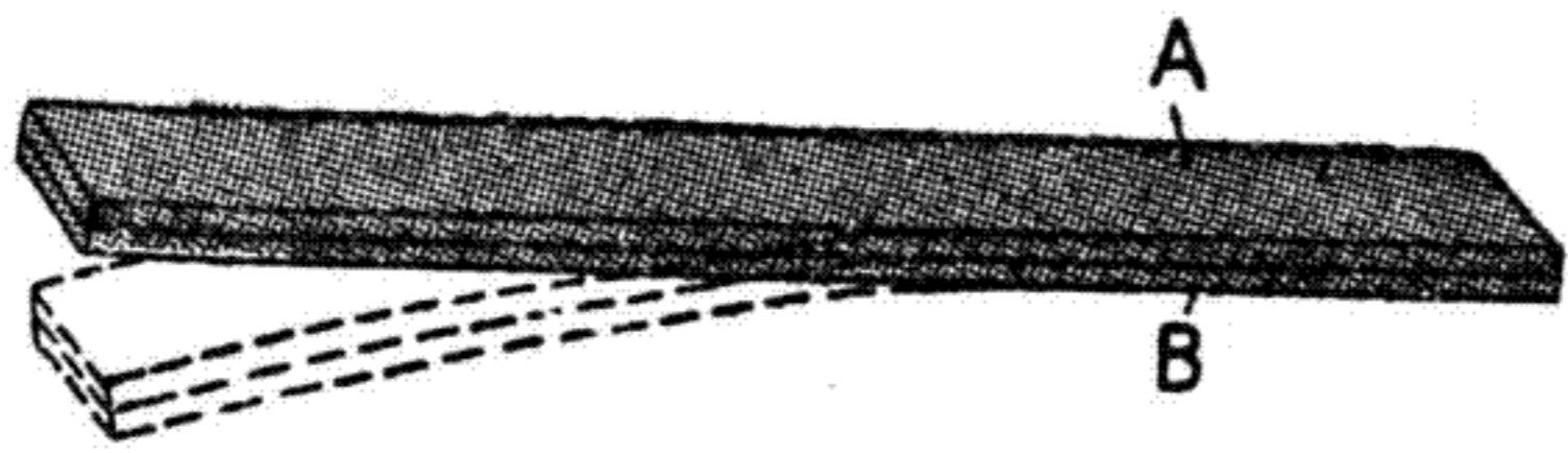
Рис. 96. Изгиб биметаллической пластинки при нагревании: A — пластинка одного металла, B — другого.
