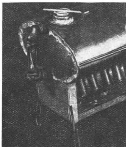
Рис. 14. Фото котла со стороны водомерного стекла и водоналивного отверстия.
